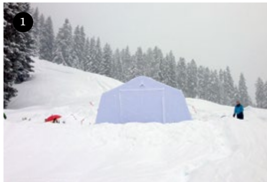
Der Testort in Prags im Pustertal: ein Zelt an einem Abhang mit einer eigens aufgeschütteten Lawine. An drei unterschiedlichen Wochenenden zwischen Januar und März 2014 führten die Forscher hier experimentelle Tests durch: im Hochwinter mit frischem lockerem Schnee, sodann bei umgewandeltem älterem Schnee mit mittlerer Dichte und schlussendlich bei feuchtem Frühjahrschnee mit hoher Dichte.
