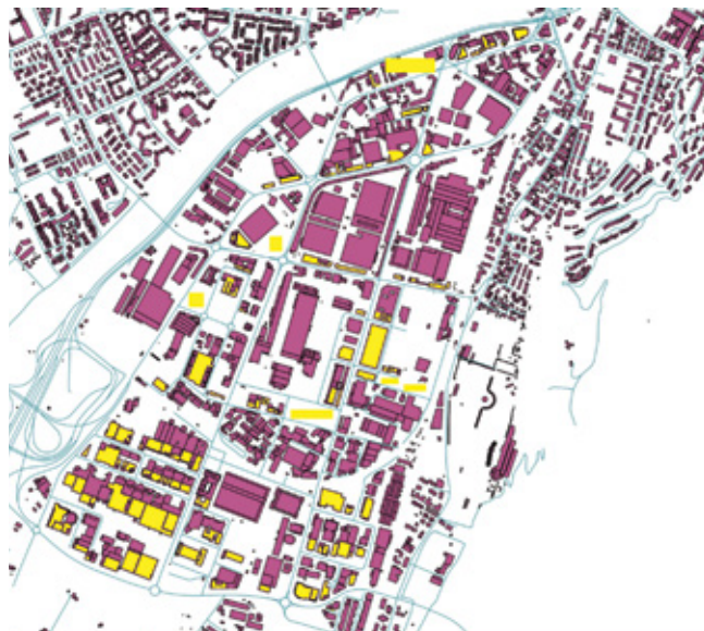
Figura 9: Identificazione degli edifici considerati (in giallo) per il calcolo del potenziale FV in facciata
