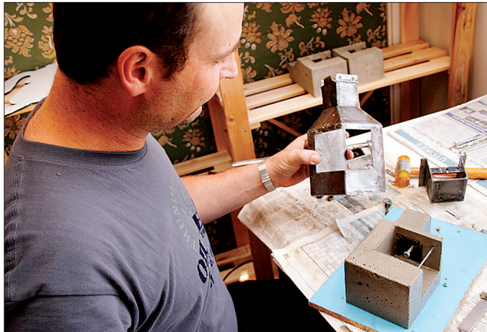
Calle Rosvall kan pusta ut, miniatyrspisen är lyckligen befriad från gjutformen. Nu skall den torka i minst en vecka innan det är dags för målning.
